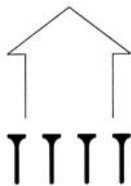
ALETA TIPO 1 Descarga recta VANE TYPE 1 Straight flow pattern AILETTE TYPE 1 Soufflage droit
